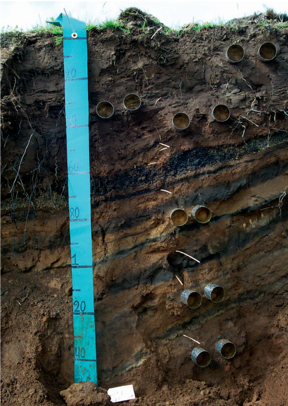
Mynd 12.3. Mælingar á rúmþyngd jarðvegslaga í sniði nálægt Gullfossi. Dósir (frá Ora í þessu tilfalli) sem eru opnar í báða enda eru reknar varlega inn í tiltekið jarðvegslag. Síðan er skorið frá dósunum og þær teknar, moldin þurrkuð og vegin til að ákvarða rúmþyngd. Að lokum er jarðvegurinn sigtaður til að kanna hvort korn >2 mm séu til staðar en þau þarf að draga frá (vigt og rúmmál). Þetta snið einkennist af mörgum grófum gjóskulögum úr Heklu og Kötlum. Myndin tengist BSc-verkefni Rannveigar Guicharnaud (2002), en hún rannsakaði rúmþyngd moldar vítt og breitt um landið.
